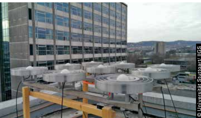
Mit Hilfe einer Software des IIGS kann handelsübliche GPS-Technik kostengünstig aufgerüstet und für millimetergenaue Messungen eingesetzt werden.
