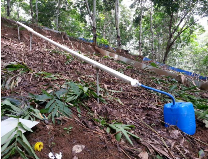
图 5 - 安装于中年橡胶林的穿透雨收集装置
