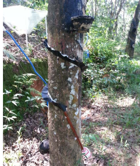
图 6 - 安装于老年橡胶的树干径流采集器
