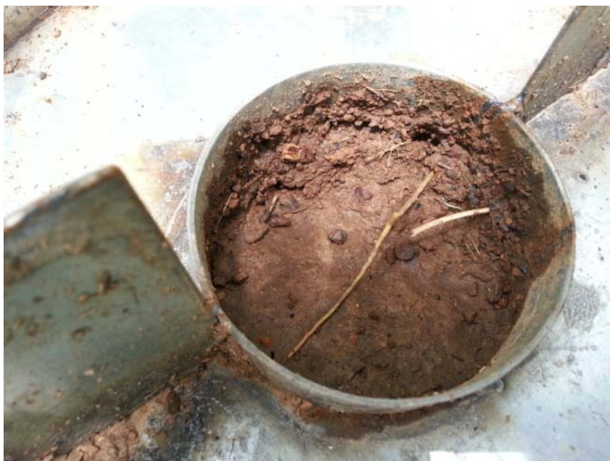
图 5 泼溅杯观测到的明显的泼溅侵蚀
